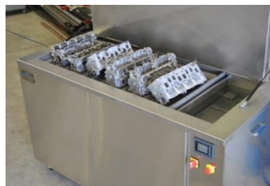
Fig. 1 Macchina ad ultrasuoni impiegata nel lavaggio del motore
