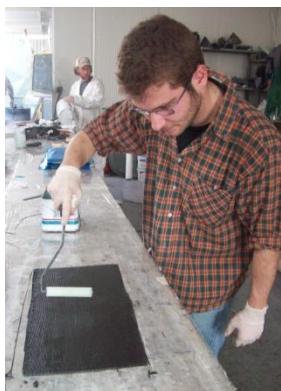
Una fase del processo di laminazione dei provini in fibra di carbonio
